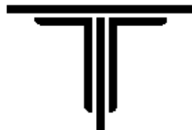
43. ábra Úgynevezett vékony keresztmetszet ábrázolása metszetben
