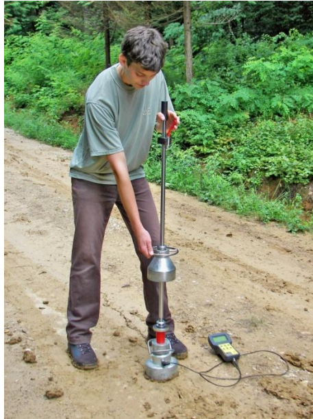
Könnyűejtősúlyos dinamikus teherbírás mérés
