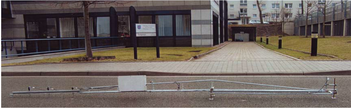
4.19. ábra. Automatizált Benkelman-tartó, Németország (Dähnert, 2005).
