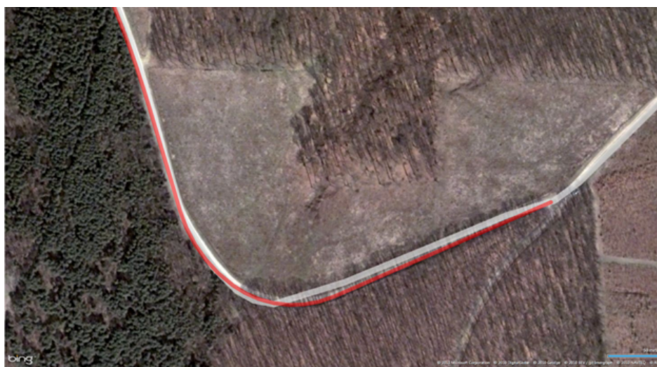
1.9. ábra. Rekonstruált úttengely (piros vonal), Bing Maps vektor réteg (fehér vonal).
