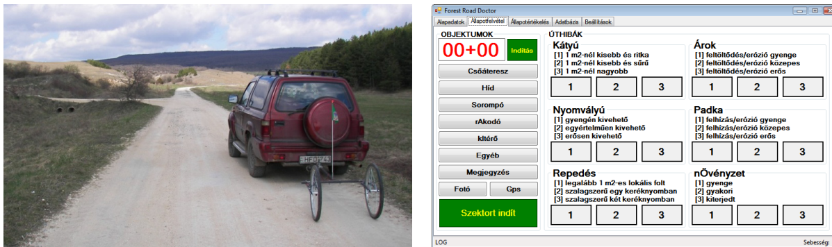
3.6. ábra. A továbbfejlesztett mérőkocsi (a) és az adatgyűjtő szoftver (b).
