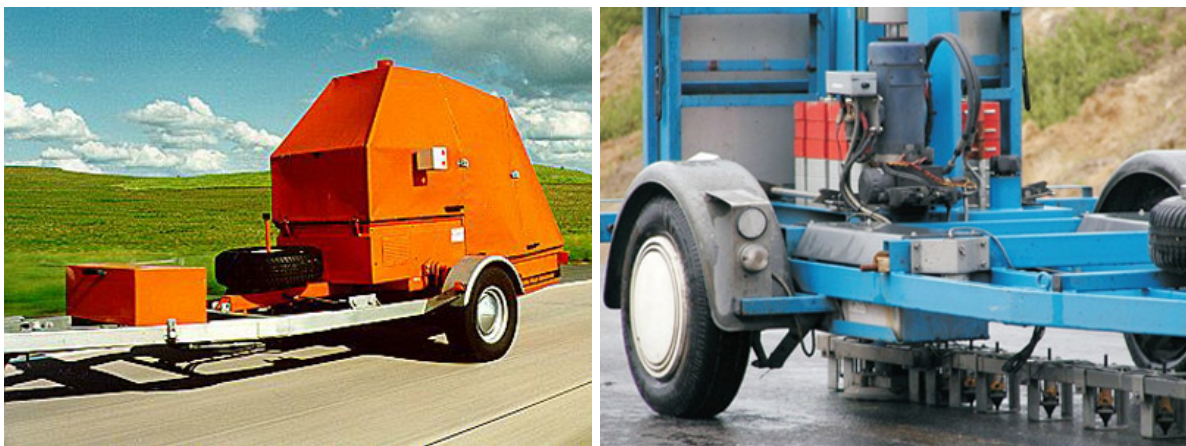
4.12. ábra. KUAB (a) és Dynatest típusú (b) FWD készülékek.
