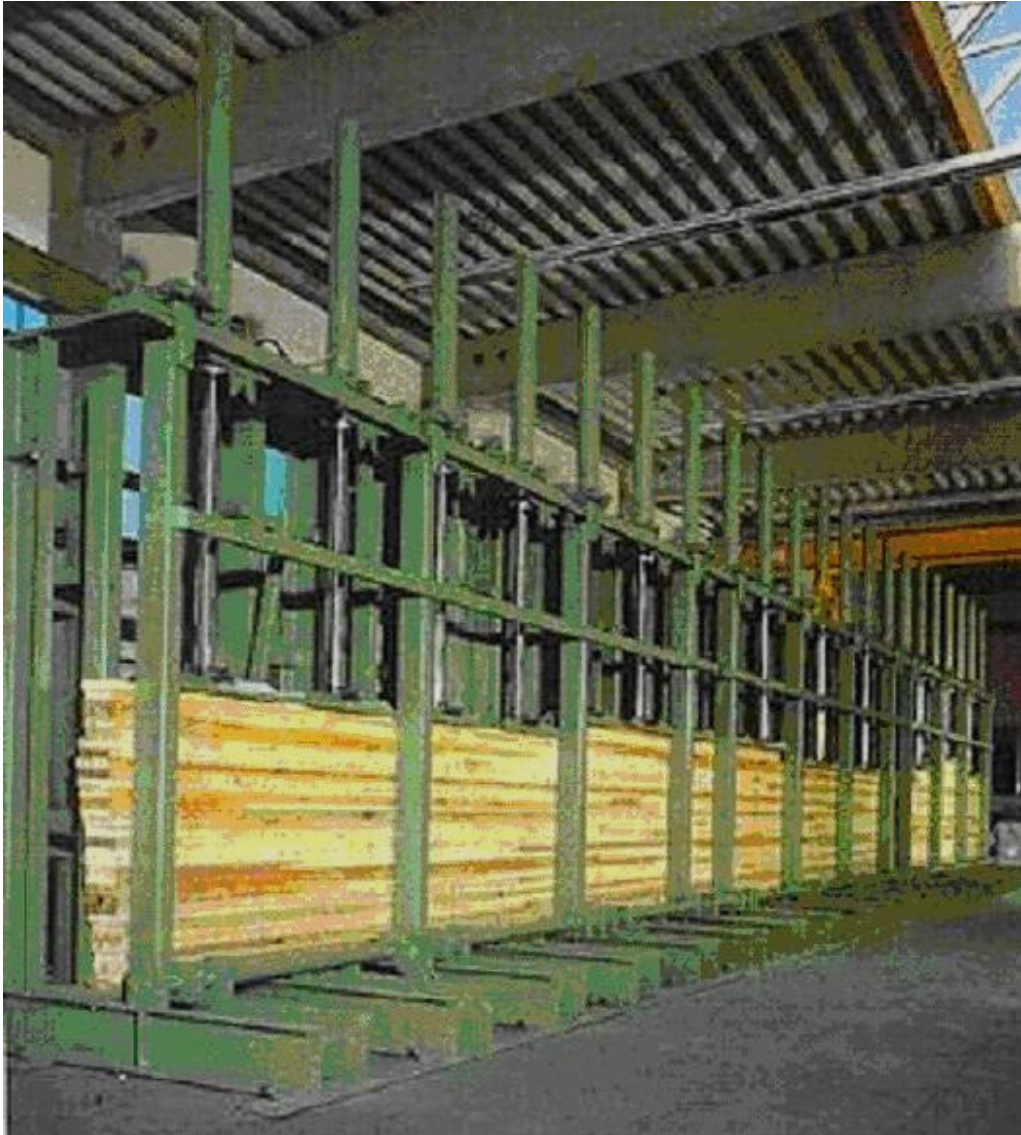
6. ábra – Függőleges elrendezésű RR-tartó prés
