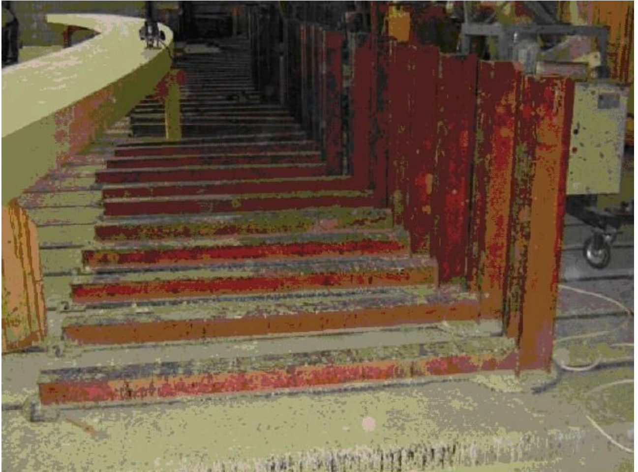
7. ábra – Betonozott sínrendszerhez rögzített préság
