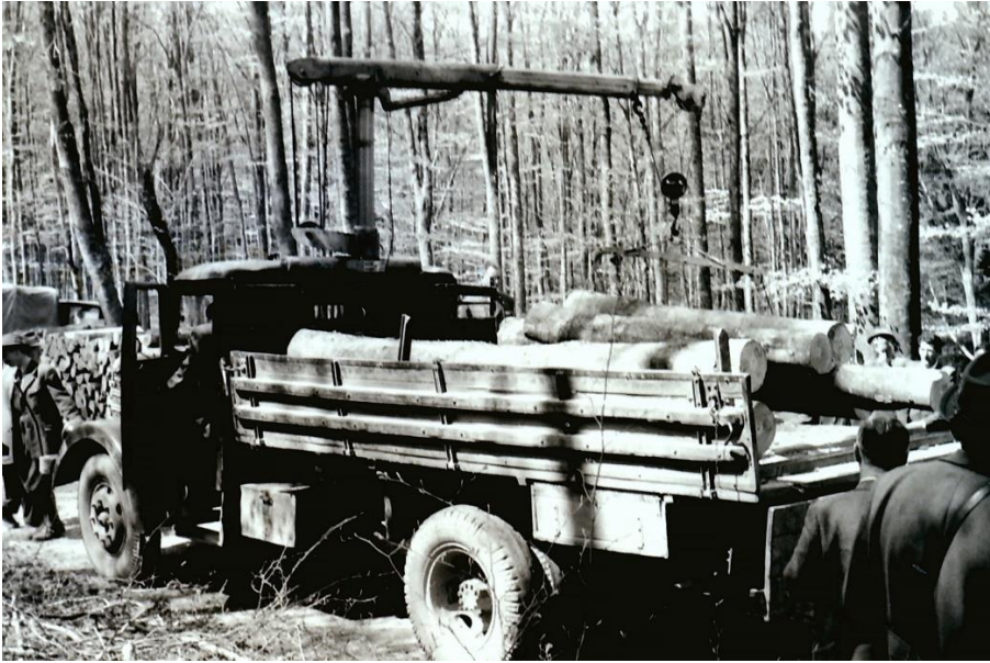
Hiab darus Csepel tehergépkocsi rakodás közben
